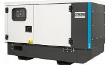
Дизельный генератор QIS 16 (230V) мощностью 10,9/10,9 кВт при основной нагрузке, имеет ёмкость топливного бака 55 литров и его топливная автономность при сто процентной нагрузке составляет 15,7 часа. Двигатель Kubota D1703-M-BG , объёмом 1,7 литров обеспечивает экономичную и, относительно, мало шумную работу генератора.
